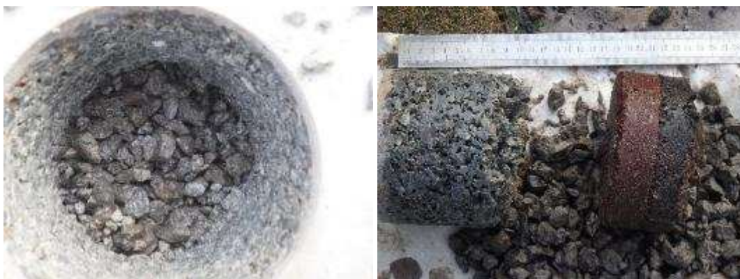
Carottage dans béton poreux avec gravier d'isolation 10/20 mm – coupe sur structure
