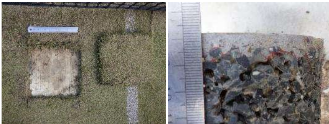
Découpe du gazon synthétique – détail en coupe sur ragréage hydraulique
