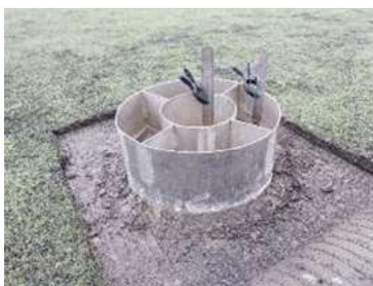
Mesure de vitesse d'infiltration verticale de l'eau en surface de la grave
