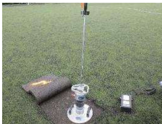
Plaque dynamique légère en service, mesure sur la couche de fondation
