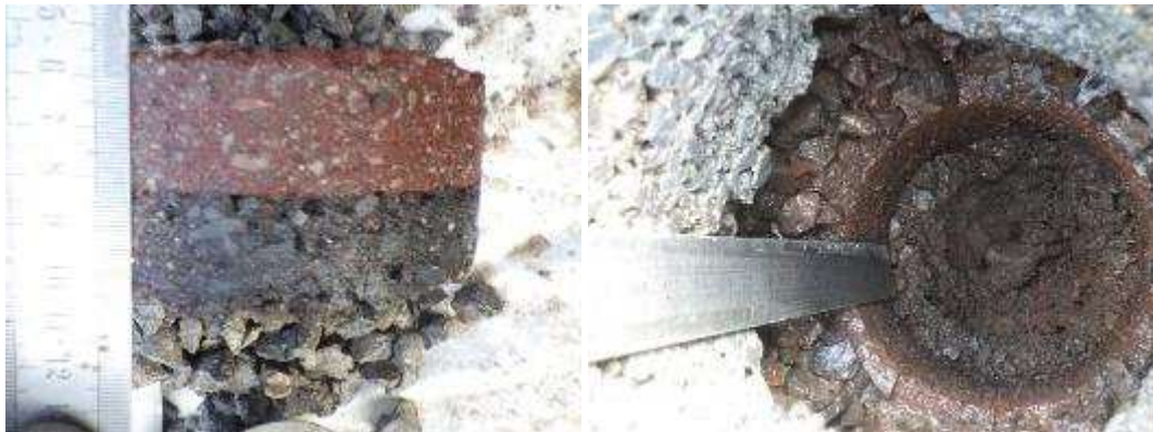
Coupe sur couche bitumeuse bicolore – sondage dans couche de fondation sous bétons bitumineux
